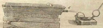
Фиг. 93. Способъ видѣнія амміака изъ азотистыхъ органическихъ веществъ. Смѣсь такого вещества съ натристой известью вводятъ въ трубку, которую нагреваютъ на жаровни. Выдѣляется смѣсь паровъ и газовъ. Ихъ пропускаютъ въ сосудъ а, содержащій воду или кислоту. Въ нѣхъ растворяется амміакъ газъ.
