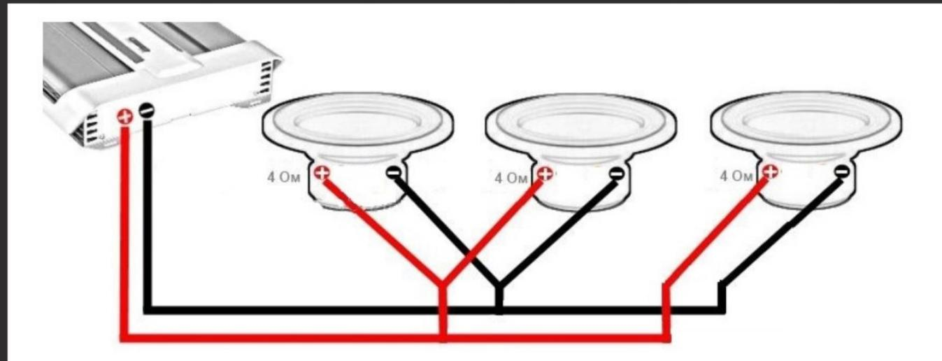
В результате получается, что сигнал на каждый из элементов схемы приходит одинаковый. А ток разделяется на «ручейки», то есть становится меньше. И ток, который протекает через динамик, зависит от сопротивления этого элемента.
