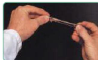
Рис. 26. Внешний вид пластической серы
