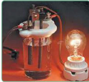
Рис. 8. Электролизёр — прибор для определения электропроводности растворов
